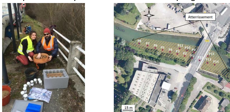
Figure 2 : Prélèvements des sédiments à Pont-Saint-Marie (Aube) et plan de localisation des échantillonnages (Source Google Map et photographie personnelle)
